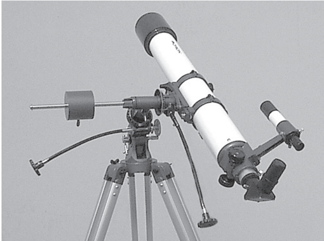
Abbildung 6a. Das Teleskop zeigt nach Süden. Beachten Sie, dass die Montierung und das Stativ in all diesen Darstellungen nicht bewegt werden, sondern nur die Rektaszensions- und Deklinationsachse eingestellt wird.
