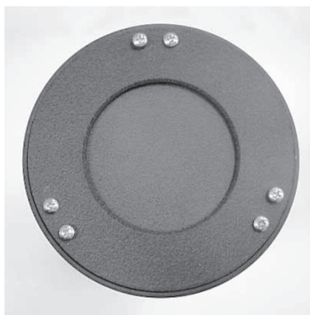
Abbildung 11. Das hintere Ende des Optikrohrs (Unterseite der Primärspiegelzelle). Die drei Paare von Kollimationsschrauben dienen zum Einstellen der Neigung des Primärspiegels.
