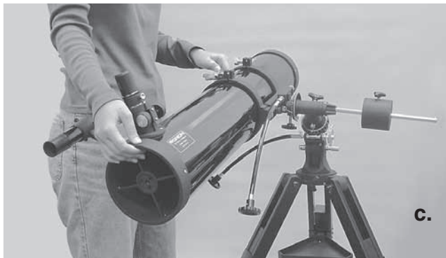
Abbildung 4a, 4b, 4c, 4d. Um eine ordnungsgemäße Funktion der parallaktischen Montierung zu gewährleisten, muss das Optiktrohr des Teleskops sowohl auf der RA- als auch der Dek-Achse optimal ausbalanciert sein. (a) Lockern Sie die RA-Arretierschraube, und schieben Sie das Gegengewicht so an der Gegengewichtsstange entlang, dass ein perfektes Gleichgewicht mit dem Optiktrohr herrscht. (b) Wenn Sie die Hände nun vom Teleskop nehmen, sollte sich das Optiktrohr von selbst nicht mehr nach oben oder unten bewegen. (c) Lockern Sie die Dek-Arretierschraube und die Rändelschrauben der Rohrschellen um einige Umdrehungen, und schieben Sie das Teleskop in den Rohrschellen je nach Bedarf vor oder zurück. (d) Wenn das Optiktrohr auf der Dek-Achse optimal ausbalanciert ist, wird es seine Position auch dann beibehalten, wenn Sie die Hände vom Teleskop nehmen.
