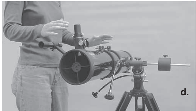
Abbildung 4a, 4b, 4c, 4d. Um eine ordnungsgemäße Funktion der parallaktischen Montierung zu gewährleisten, muss das Optiktrohr des Teleskops sowohl auf der RA- als auch der Dek-Achse optimal ausbalanciert sein. (a) Lockern Sie die RA-Arretierschraube, und schieben Sie das Gegengewicht so an der Gegengewichtsstange entlang, dass ein perfektes Gleichgewicht mit dem Optiktrohr herrscht. (b) Wenn Sie die Hände nun vom Teleskop nehmen, sollte sich das Optiktrohr von selbst nicht mehr nach oben oder unten bewegen. (c) Lockern Sie die Dek-Arretierschraube und die Rändelschrauben der Rohrschellen um einige Umdrehungen, und schieben Sie das Teleskop in den Rohrschellen je nach Bedarf vor oder zurück. (d) Wenn das Optiktrohr auf der Dek-Achse optimal ausbalanciert ist, wird es seine Position auch dann beibehalten, wenn Sie die Hände vom Teleskop nehmen.
