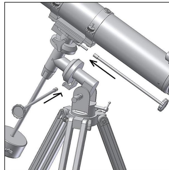
Figura 7. Posizionare le due maniglie di AR e Dec. e fissarle.
