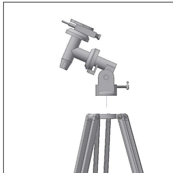
Figura 5. Posizionare la montatura equatoriale e fissarla.
