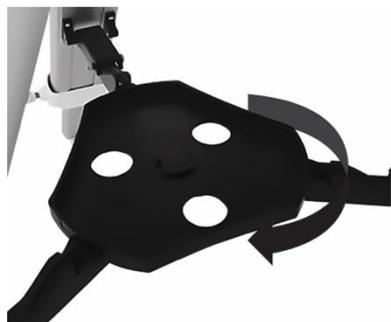
Ora è possibile posizionare la montatura Omegon EQ-320 sul treppiede. Utilizzare la vite centrale del treppiede (7) per fissare la montatura sul treppiede.
